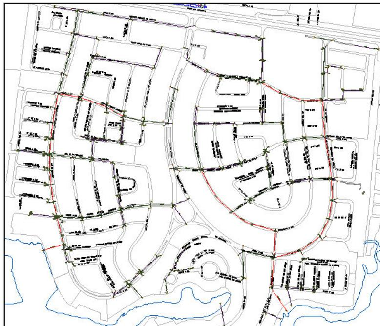
**Figura 4. Sistema de aguas lluvias de Puerto Azul**
