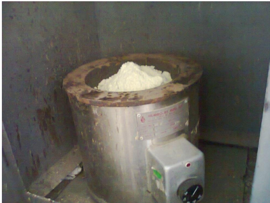
Figuras # 17 Calentando la mezcla a 115 °C
