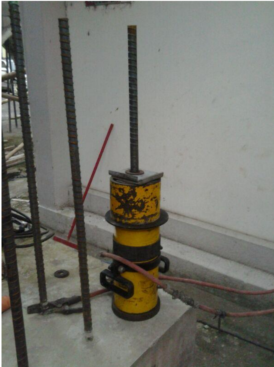
Figura # 28 Gato hidráulico con su segunda placa, listo para ser soldado.
