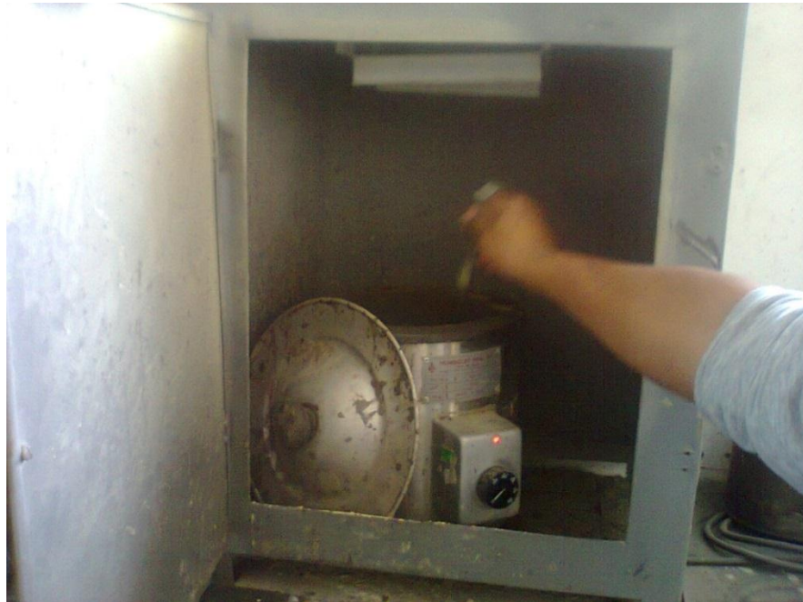
Figuras # 18 agitando el azufre antes de su fase líquida
