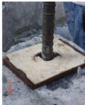
Figura # 26 Colocación de madera sobre la placa para que el gato no sufra ningún daño al empezar la prueba de tracción.
