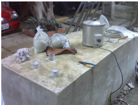
Figuras # 21 Preparación y fundición del mortero para el ensayo
