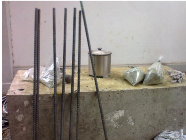
Figuras # 22 varillas, mezclas de azufre y proceso de vertido dentro del dado
