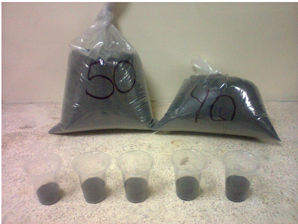
Figura # 12 Cenizas de arroz pasante del matiz 40 a 200
