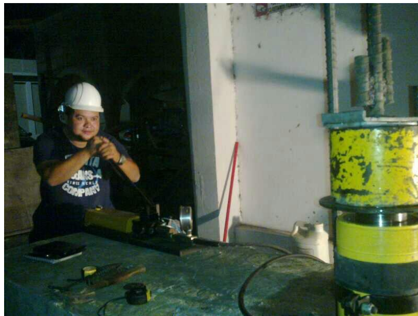
Figura # 33 Bomba de presión introduciendo aceite al gato hidráulico.
