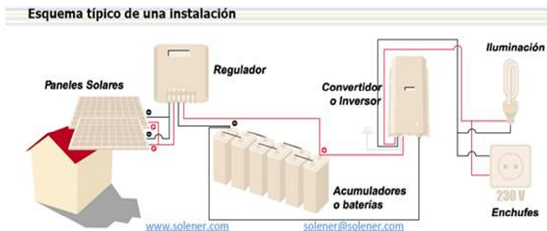
Gráfico N°11 Proceso de instalación
