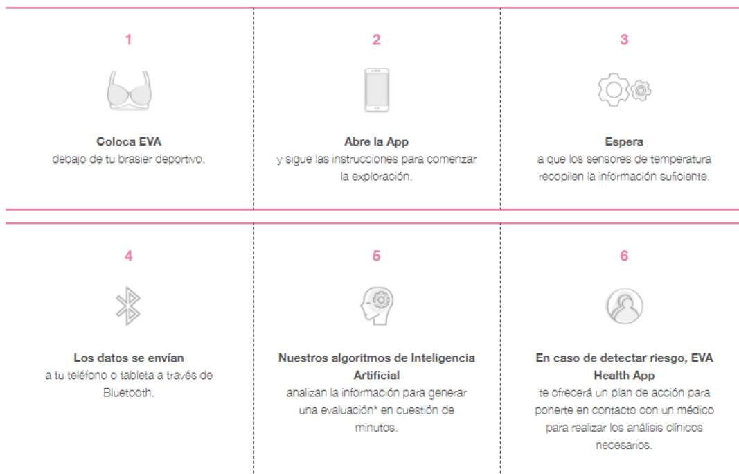
Figura 27. Proceso de funcionamiento del brasier EVA
