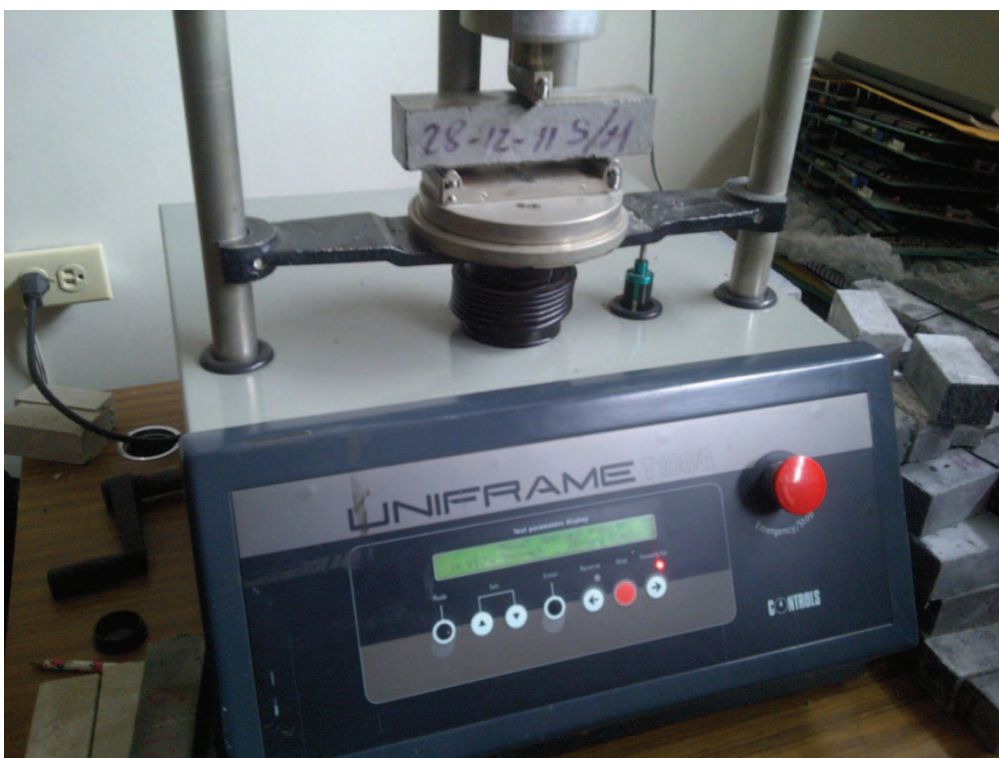
Foto 6. Equipo para análisis por flexión en probetas de mortero con y sin fibra artificial.
