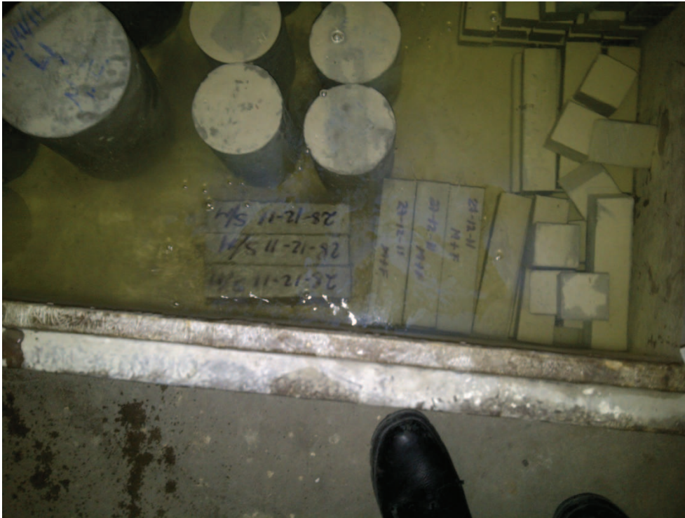
Foto 7. Piscina de Curado para las probetas
