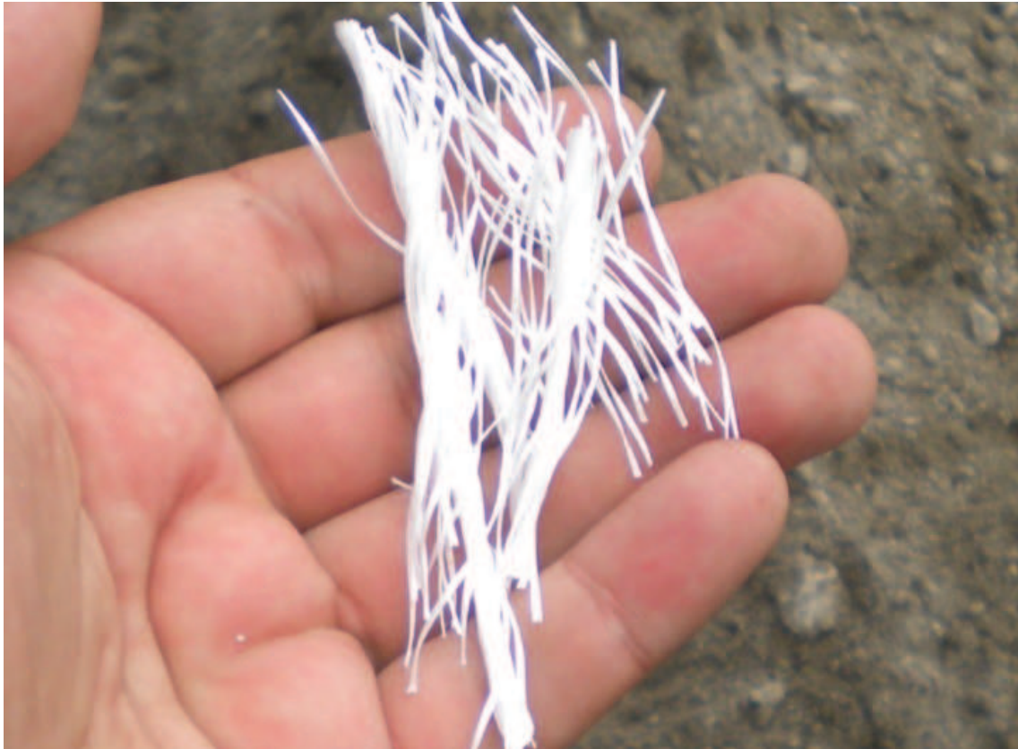
Foto 2. Fibra artificial de Polipropileno utilizada en la construcción de especímenes.
