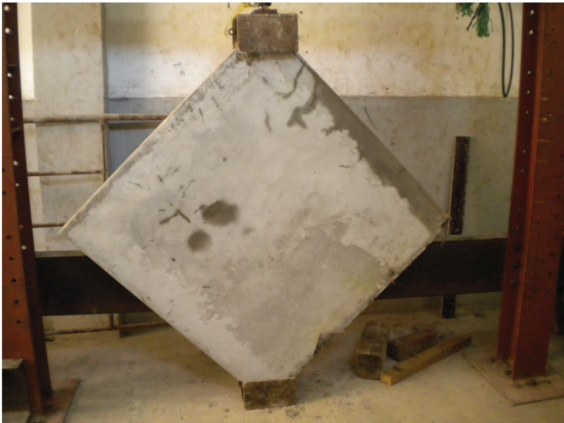
Foto 15. Especimen listo para la prueba de Resistencia a la Compresión
