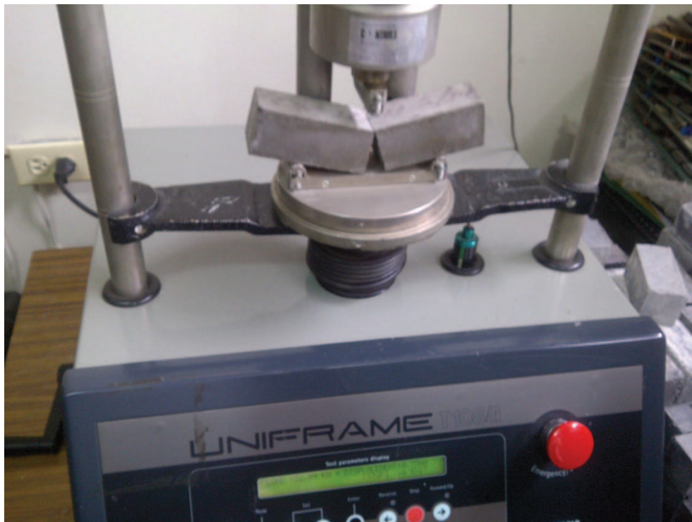
Foto 11. Probeta de mortero sin fibra partida en 2 sin fibra que la contenga
