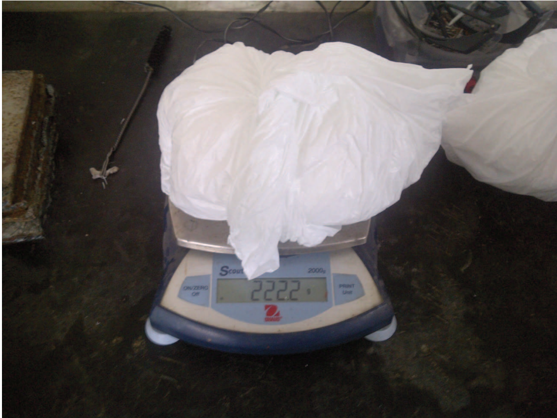
Foto 3. Balanza para calcular la dosificación de la fibra artificial por saco de cemento.
