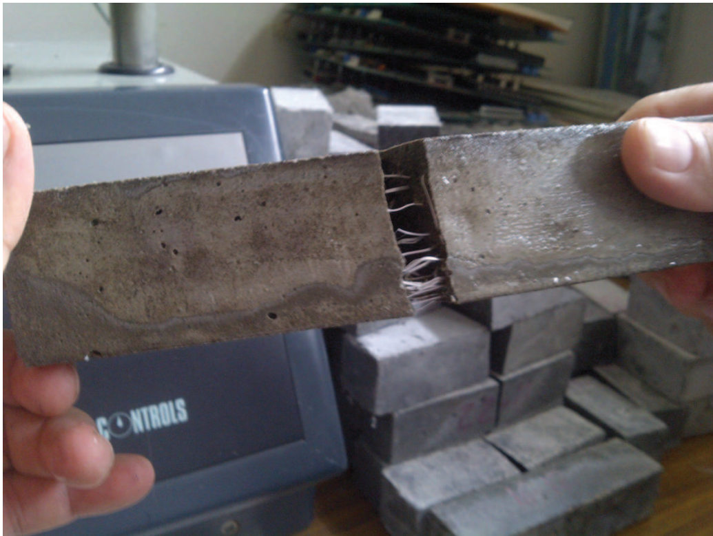
Foto 10. Probeta de mortero con fibra artificial, se muestra la tenacidad de la fibra
