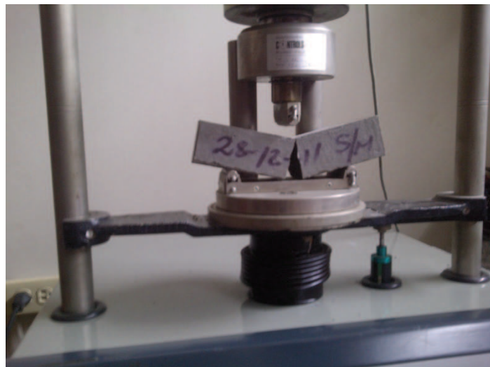
Foto 9. Probeta de mortero sin fibra ya analizada a flexión
