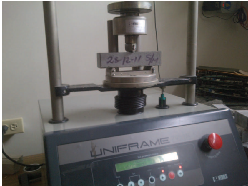
Foto 8. Probeta lista para ser ensaya a flexión
