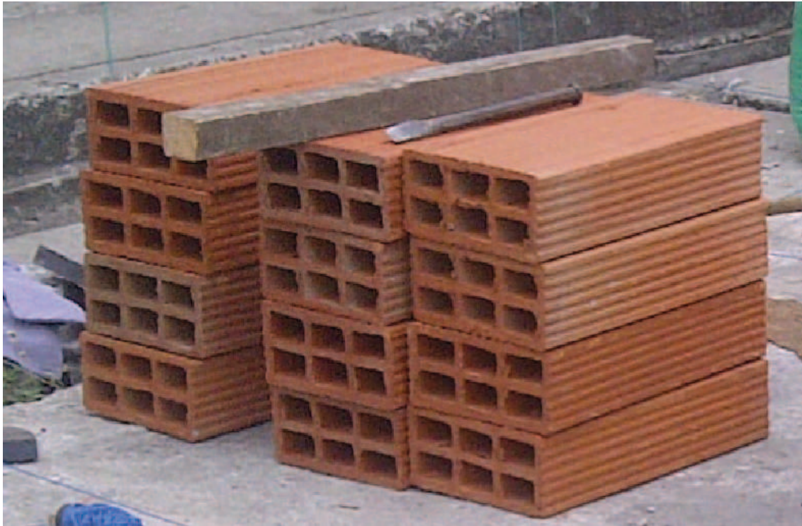
Foto 1. Bloques que se utilizaron en la construcción de los especímenes.
