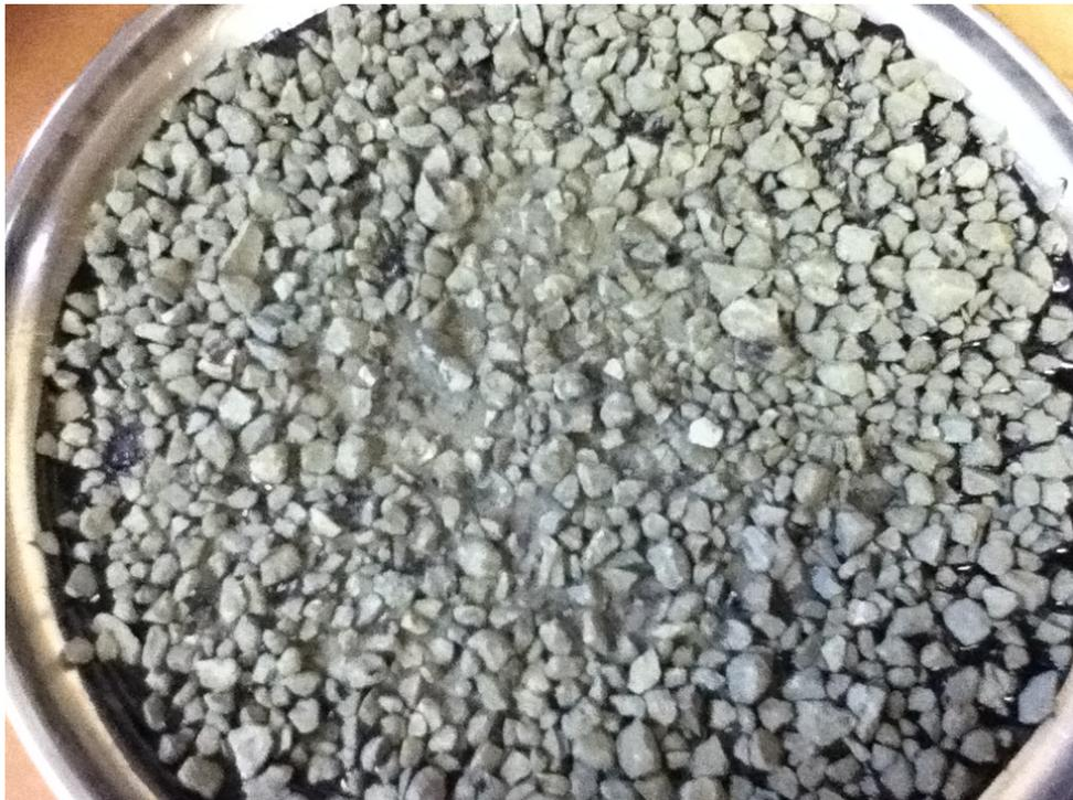
**Imagen 8.** Muestra después del ensayo de abrasión.
