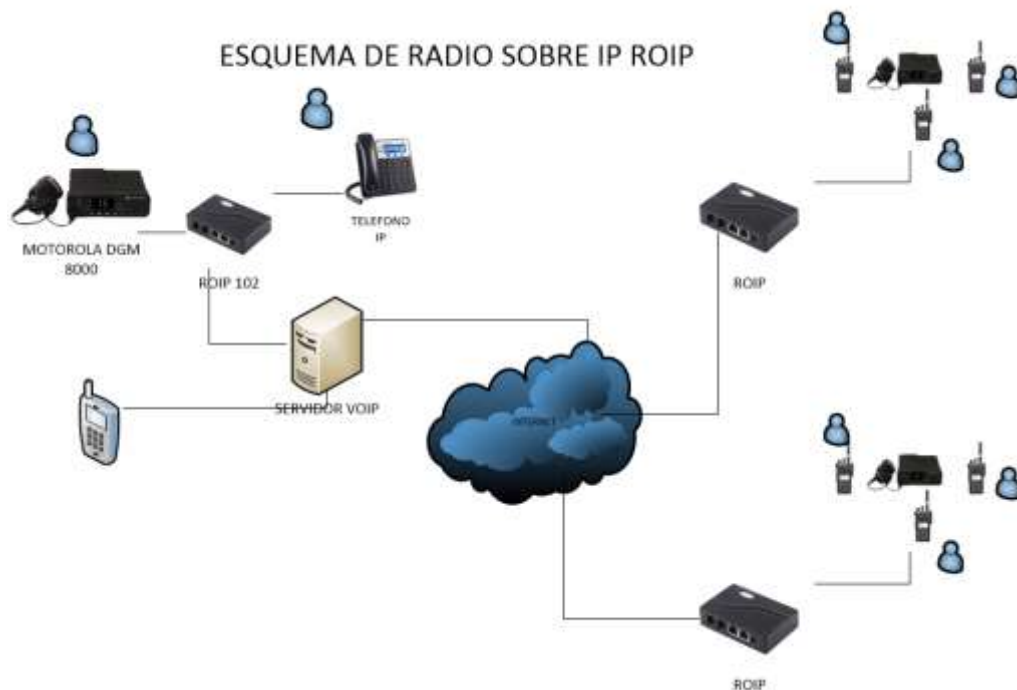
Figura 4. 1: Infraestructura de RoIP Elaborado por: Autor.
