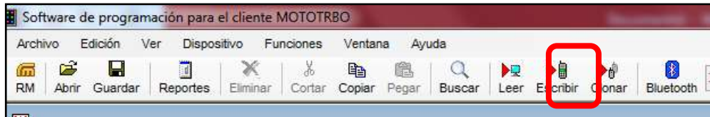
Figura 4. 29: Escribir en el radio a través software CPS Elaborado por: Autor.
