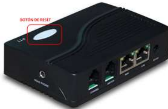
Figura 4. 12: Botón Reset equipo RoIP 102 Elaborado por: Autor.
