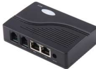
Figura 3. 2: Equipo RoIP 102 Fuente: (Davantel, 2018a)
