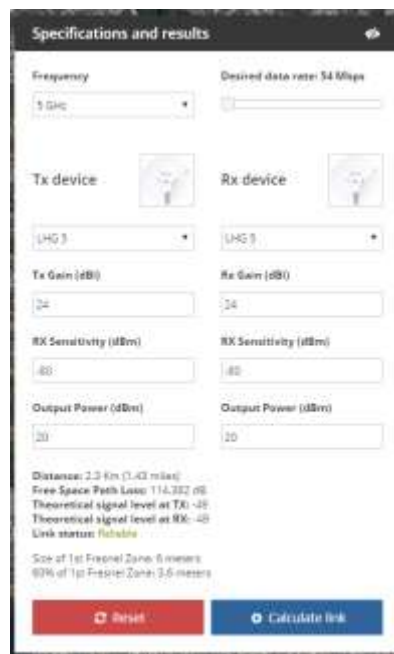
Figura 4. 9: Parámetros de simulación con antena LHG-5 Elaborado por: Autor.
