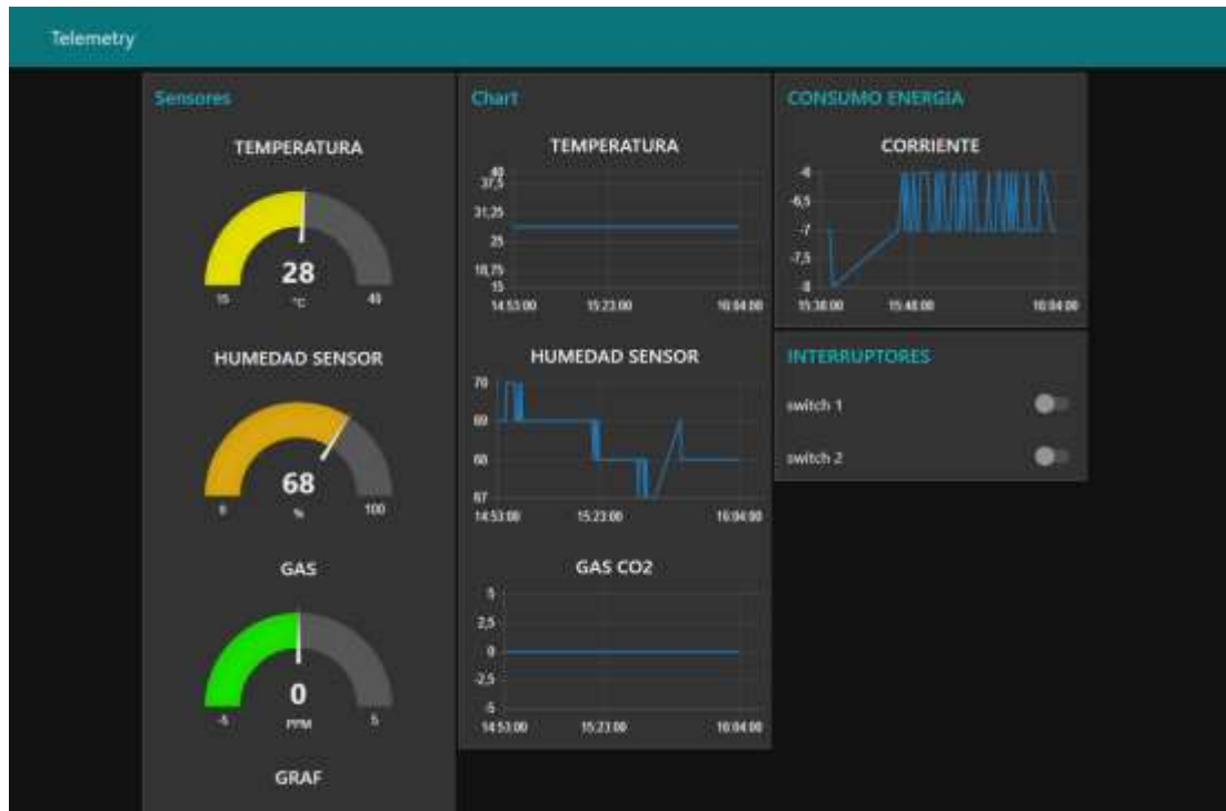
Figura 4-50: Dashboard del sistema de telemetría Elaborado por: Autor.
