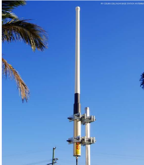
Figura 3. 4: Antena de frecuencia 900 MHz. Elaborado por: Autor
