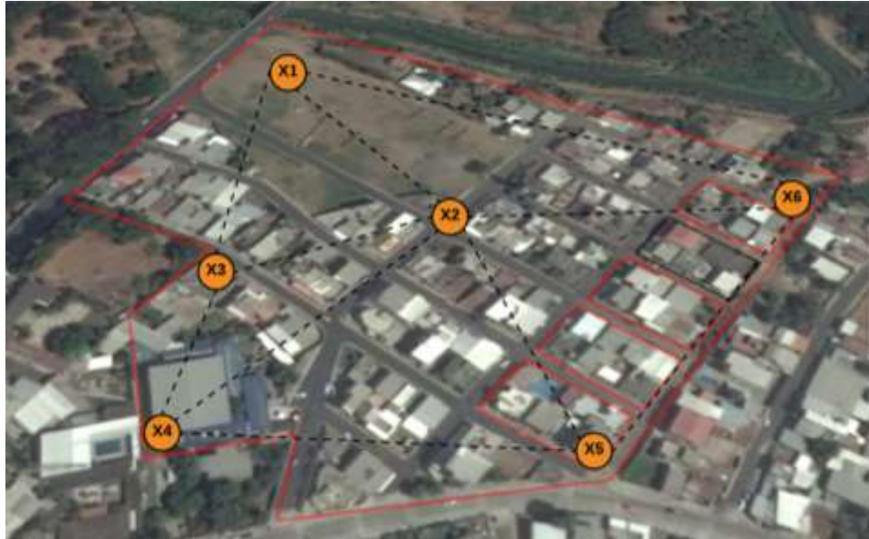
Figura 3.2. Esquema de posicionamiento de nodos en la ciudadela El Comercio para la red a implementar. Fuente: Elaborada por el autor
