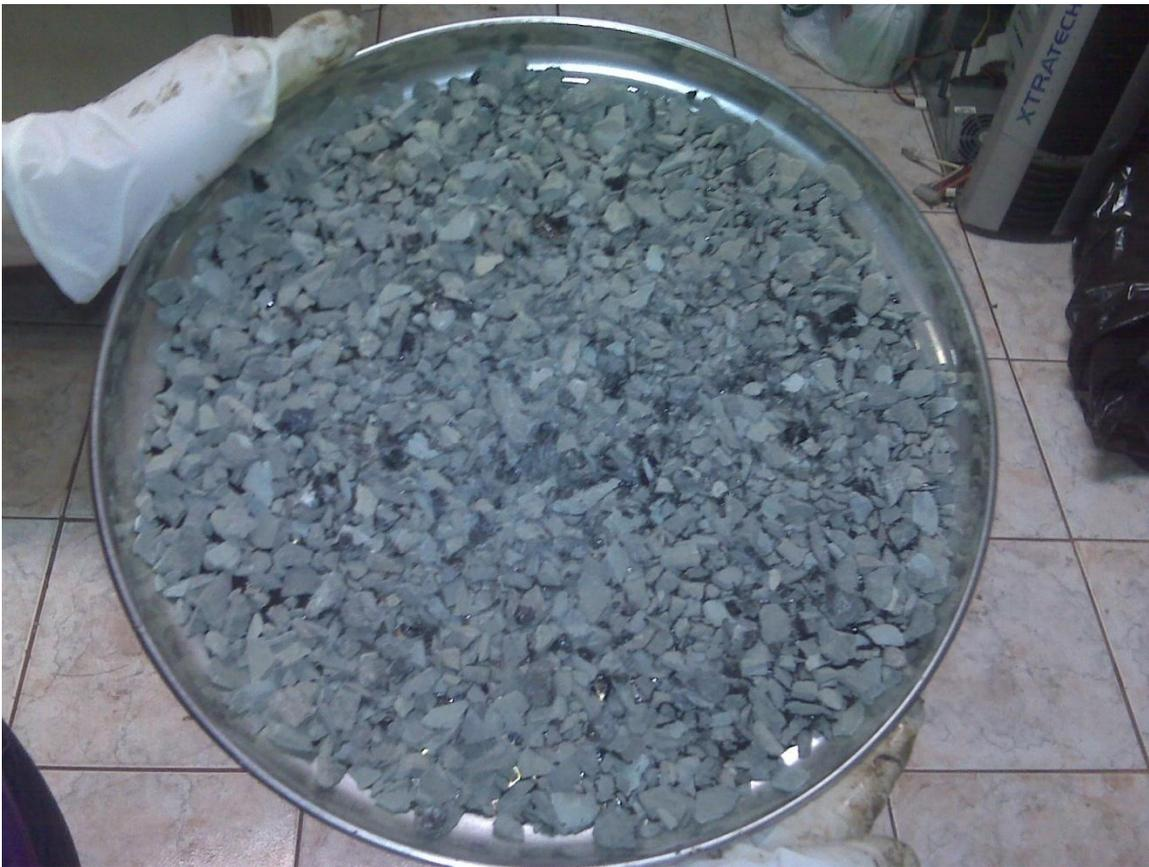
**Foto. 13 Agregado Saracay después de ensayo**
