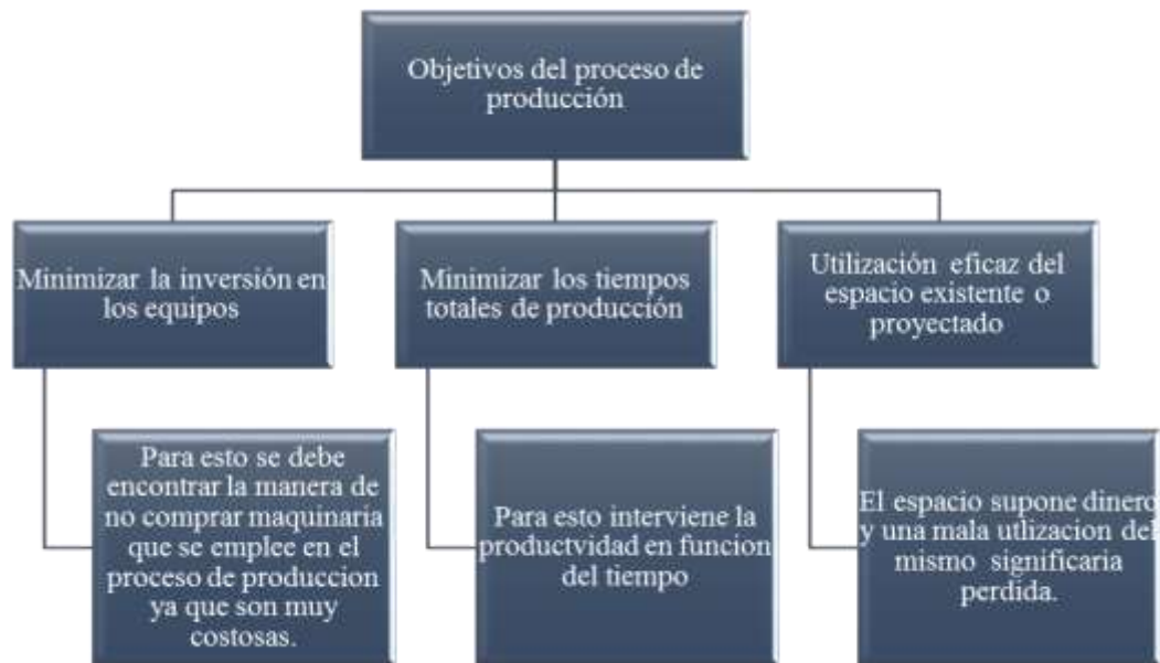
Figura 12. Objetivos del proceso de producción. Tomado de “El Sistema de producción y operaciones”.
