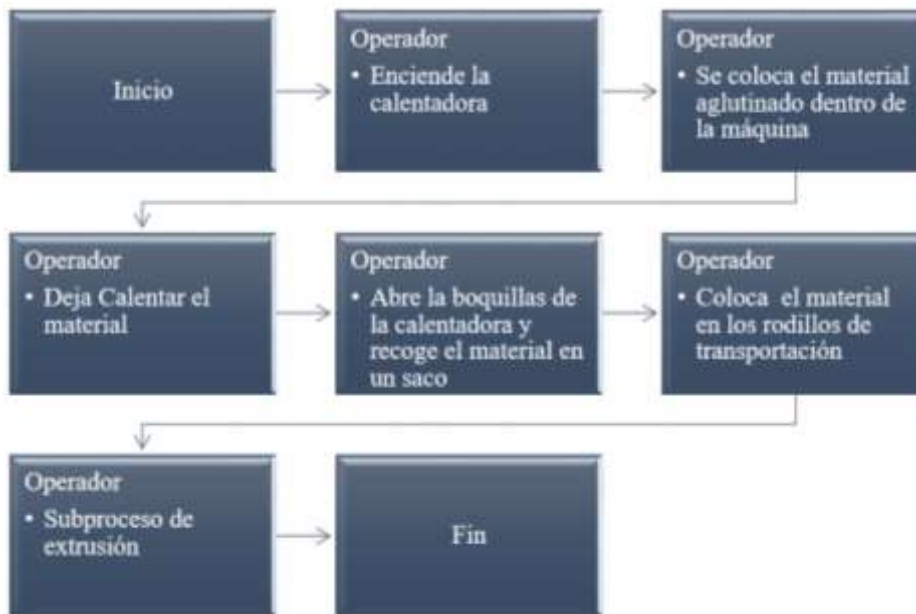
Figura 26. Diagrama de Flujo - Calentamiento de todo lo trasladado a la extrusora. Tomado de la empresa Hyperplastic.
