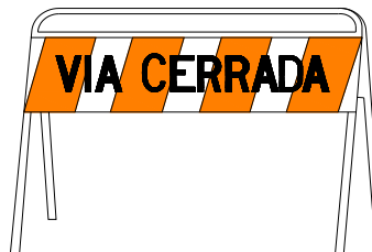
Fig. 6.3: Valla de Vía Cerrada.
