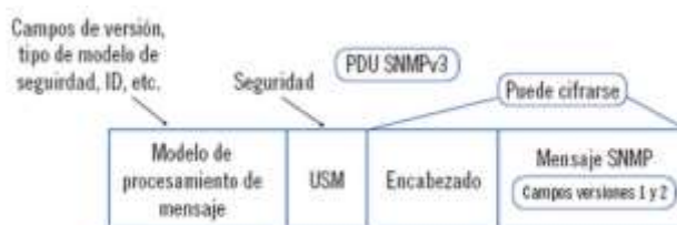
Figura 2.11: PDU del protocolo SNMPv3
