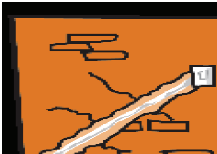
FIG 38 COLOCACIÓN DE TUBERÍA FORMA INCORRECTA
