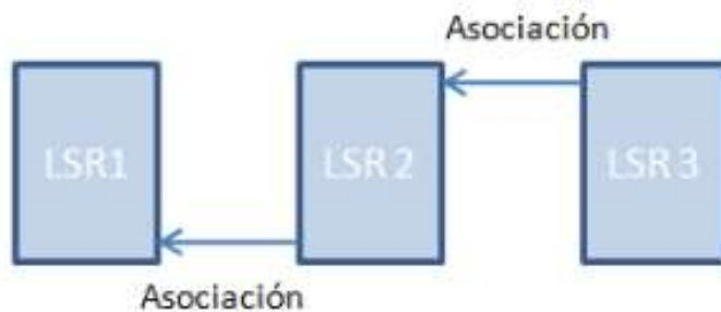
Figura 2. 4: Flujo de señalización método Unsolicited-downstream
