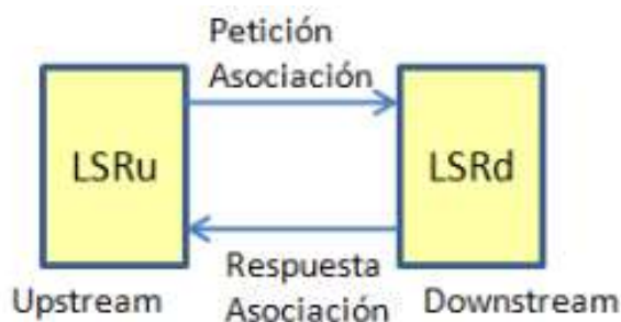
Figura 2. 3: Flujo de señalización método Downstream-on-demand
