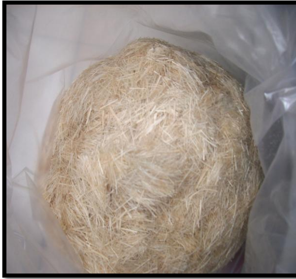
Foto 31: Fibra cortada en pedazo de 3 cm
