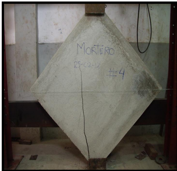
Foto 44: Pared MP a compresión diagonal
