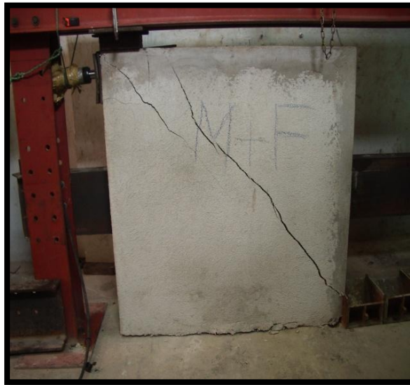
Foto 40: Falla a corte de pared MP+F
