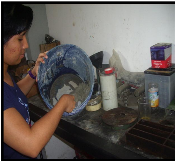
Foto 17: Colocación de la mezcla en el molde
