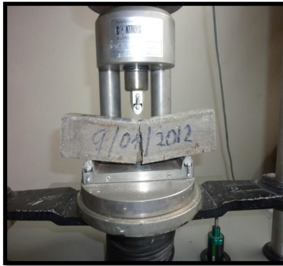
Foto 29: Falla del elemento MP+F a los 28 días
