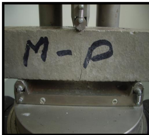
Foto 27: Falla del elemento MP a los 7 días
