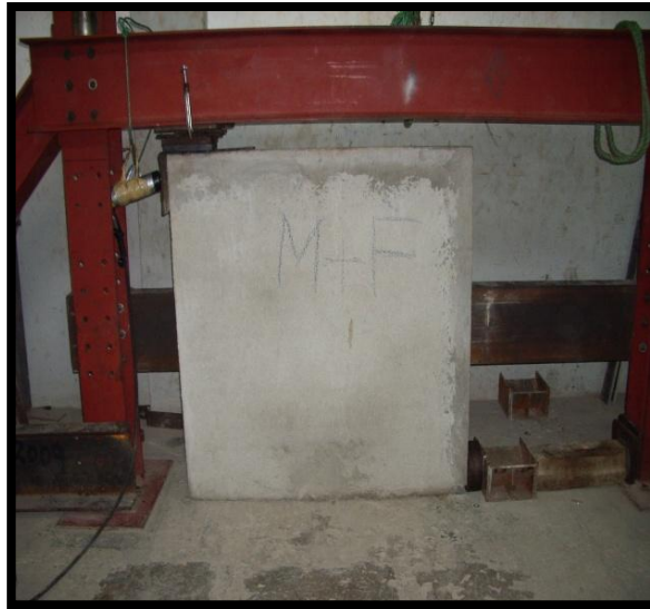
Foto 38: Montaje del ensayo de corte
