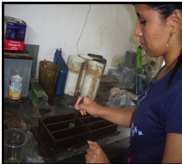
Foto 15: Limpieza del molde de la probeta
