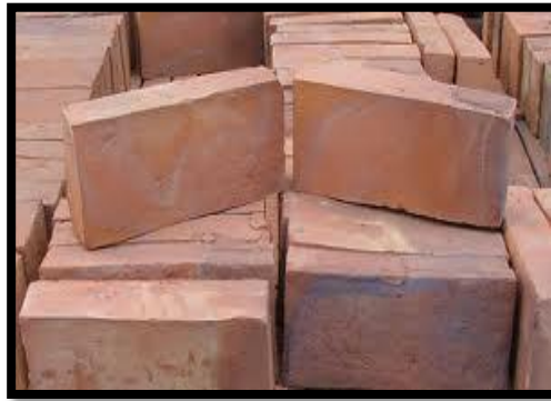
Figura 19: Ladrillo de cara vista
