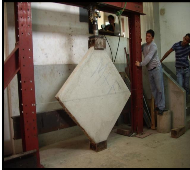
Foto 42: Pared sometida a compresión diagonal
