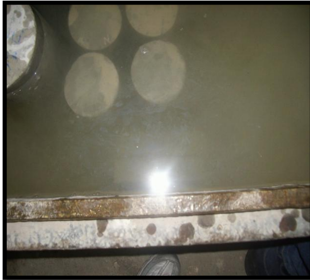
Foto 24 Curados de los moldes MP+F
