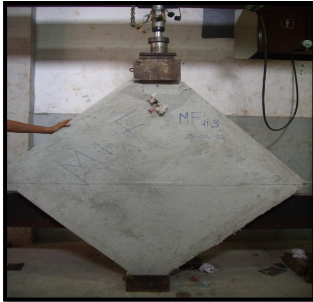
Foto 43: Pared MP+F a compresión diagonal
