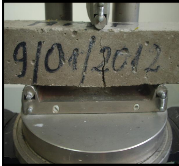
Foto 28: Falla del elemento MP+F a los 7 días
