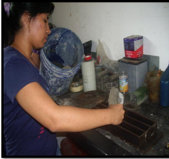
Foto 18: Colocación de la mezcla en el molde
