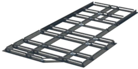
1. Cimentación Zapata corrida en dos direcciones.
