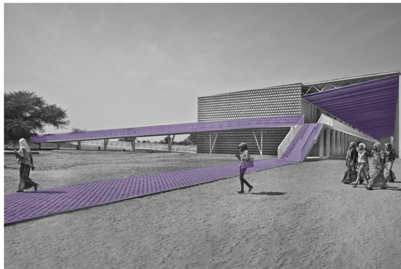
1. Uso de CELOSÍAS, para disminuir la incidencia solar y actuar como filtro de la radiación solar.
