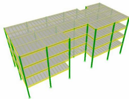
Figura 1: Columnas y vigas proyecto
