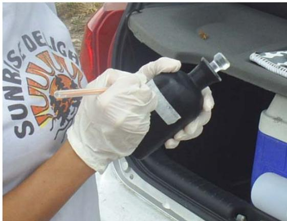
**Foto 3.4. Frasco oscuro para toma de muestra**
