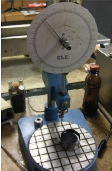
Fig. 30 Penetrómetro
