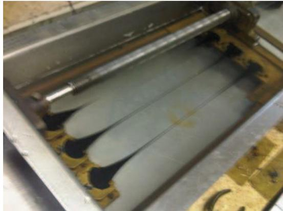
Fig. 31 Ductilímetro
