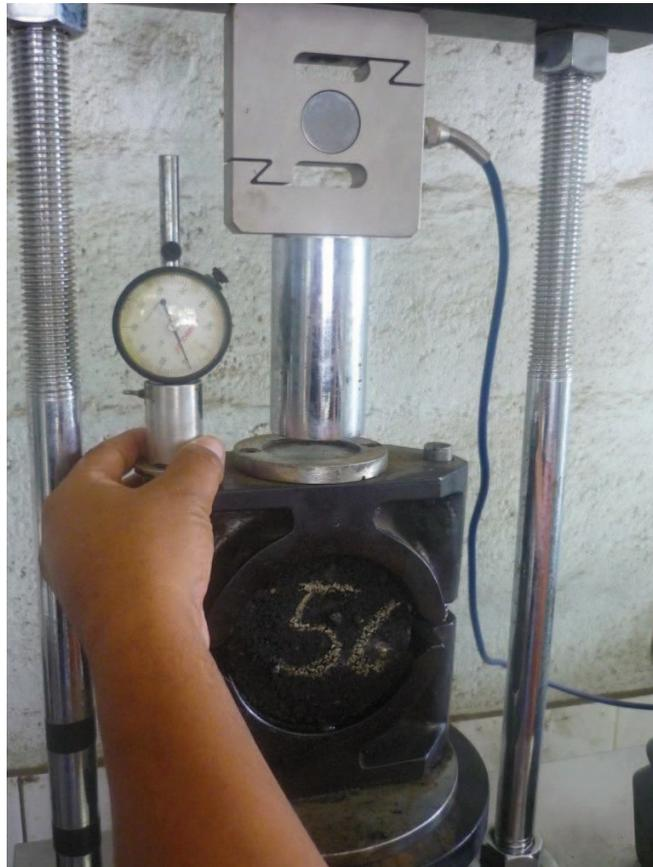
Fig. 45 Equipo de medición de Estabilidad Marshall
