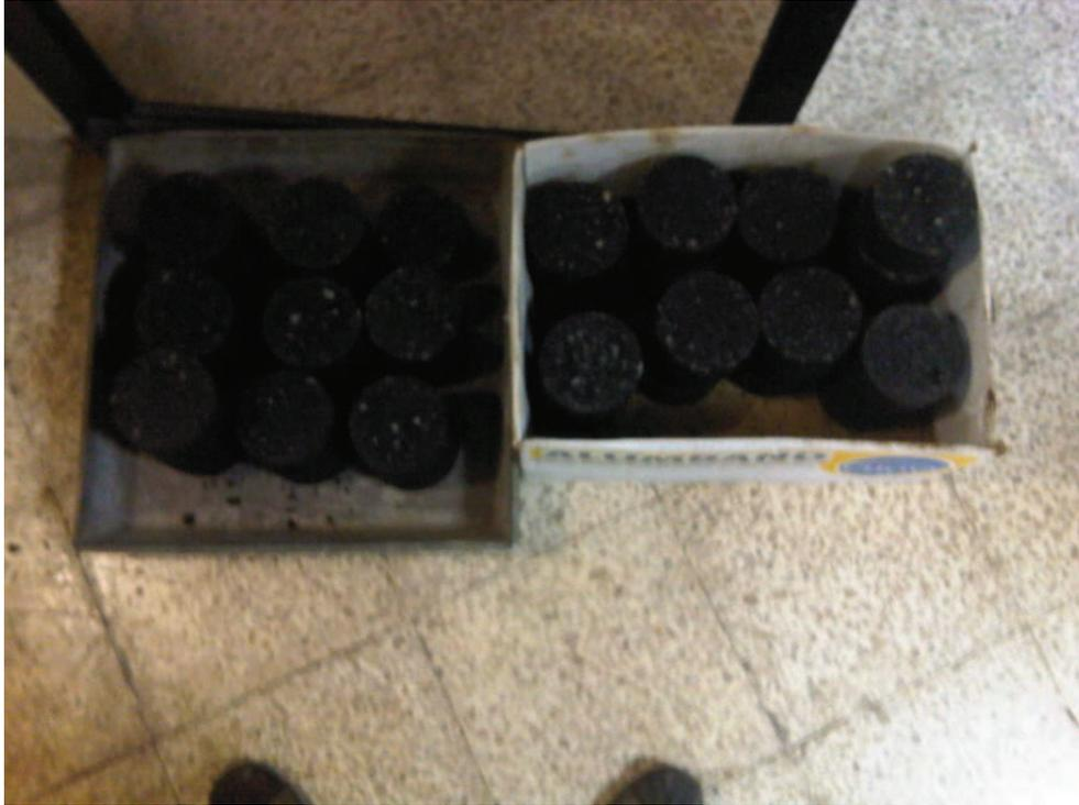
**Fig. 41 Briquetas Elaboradas Para las Pruebas**
