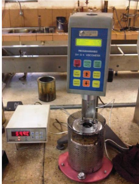
Fig. 27 Viscosímetro Brookfield
