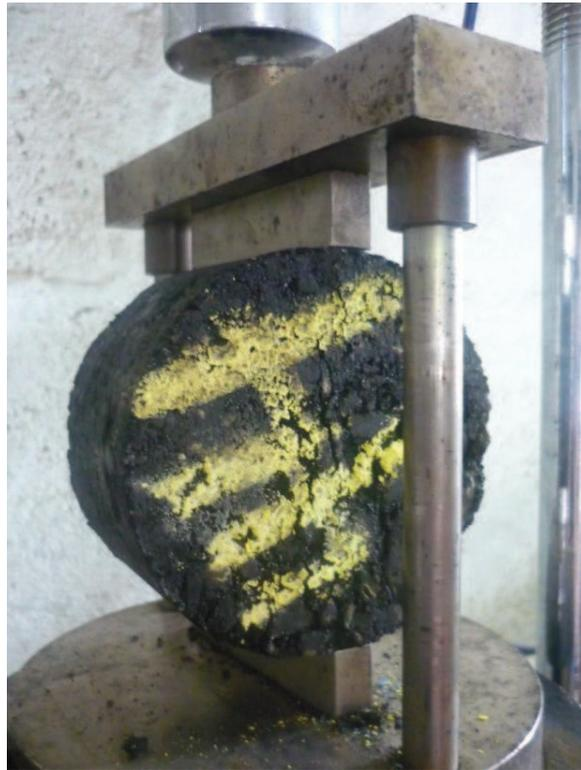
**Fig. 46 Ensayo de Tracción Indirecta**
