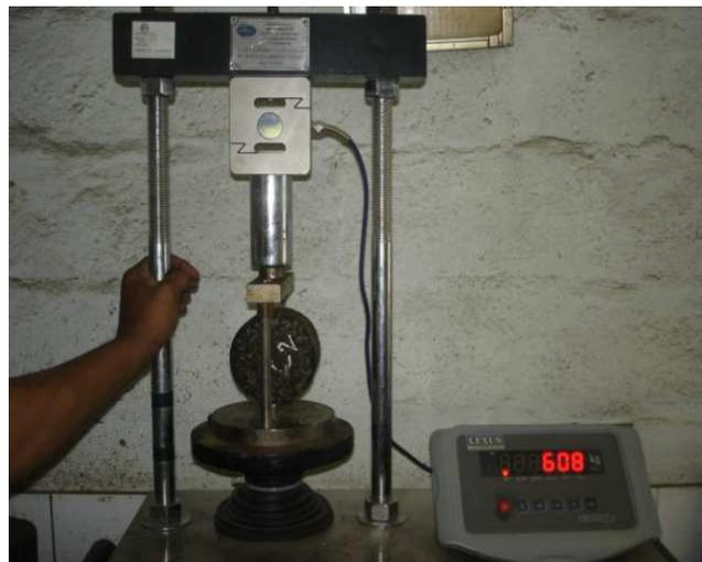
**Fig. 7.3.2.3. Aparato de compresión motorizada, colocación del espécimen y ensayo de la briqueta**
