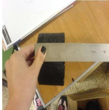
Medición del espesor
