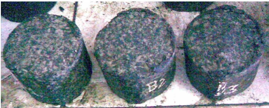
Briquetas ensayadas por método Marshall
