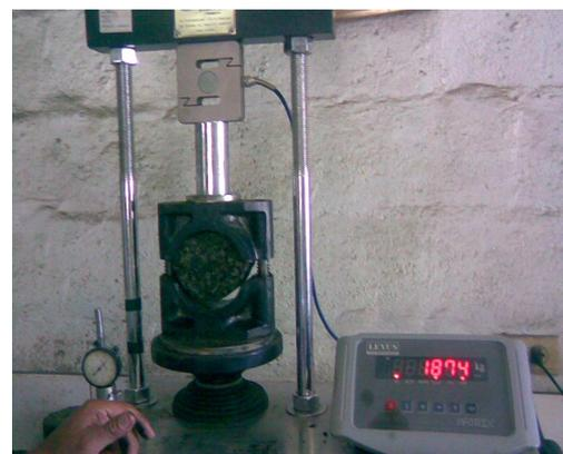
Ensayo de las briquetas
