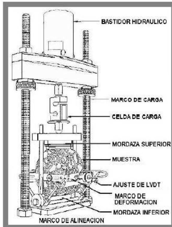
**Fig. 6.1.1 Partes del equipo**
