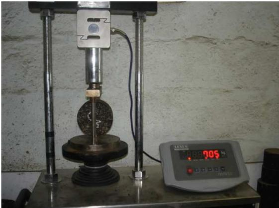
Ensayo de tracción en proceso
