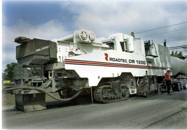
**Foto 4.1 Máquina fresadora y tren de reciclado (in situ)**
