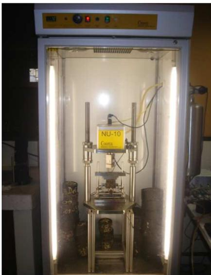
Briqueta lista para el ensayo
