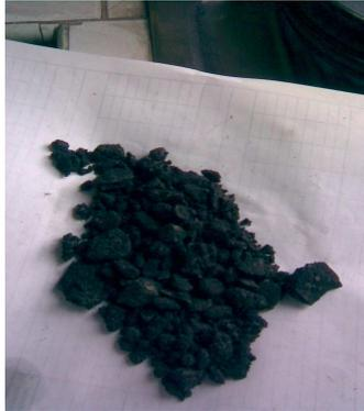
**Foto 3.4.2 Foto de adherencia de la emulsión a los agregados**
