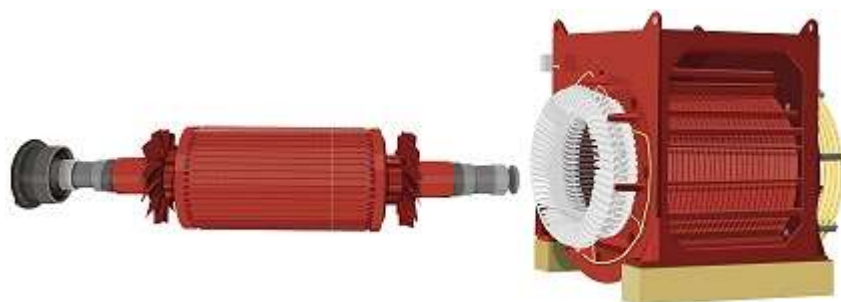
Figura 2. 12: Componentes de un generador Fuente: (Fundación Endesa)
