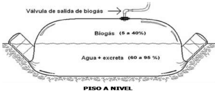
Figura 3. 1 Esquema del biodigestor
