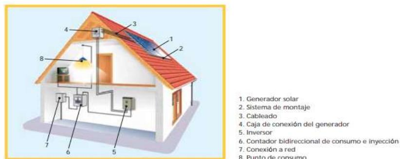
Figura 4. Elementos de una instalación fotovoltaica.
