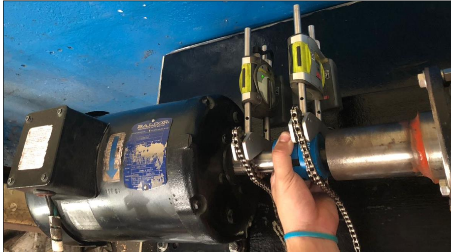
Figura 8. 9 Toma de la muestra de desalineación a 45° Elaborado: El autor
