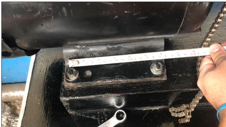
Figura 8. 6 Medición de la distancia pernos-sensor "M" Elaborado: El autor
