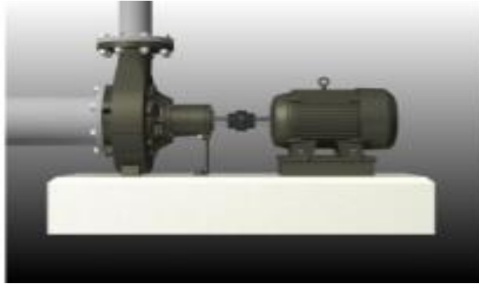
Figura 4. 2 Alineación horizontal de ejes Fuente: (Elos Fixturlaser, 2014)
