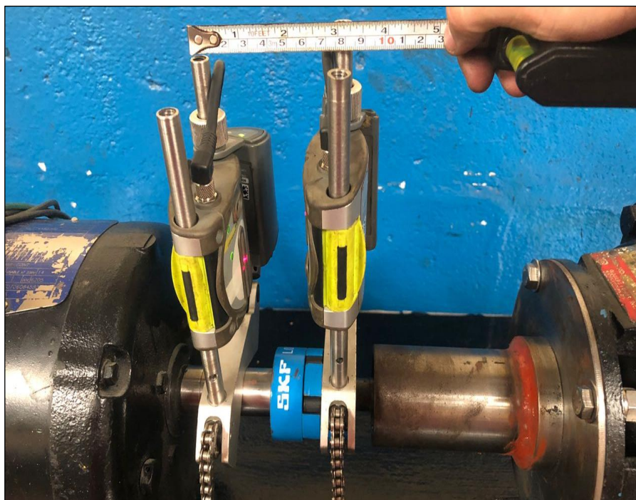
Figura 8. 5 Medición de la distancia entre sensores Elaborado: El autor
