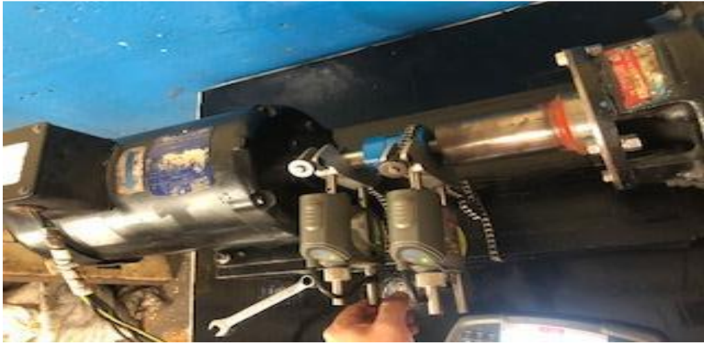
Figura 8.11 Toma de muestra de desalineación posición horizontal Elaborado: El autor
