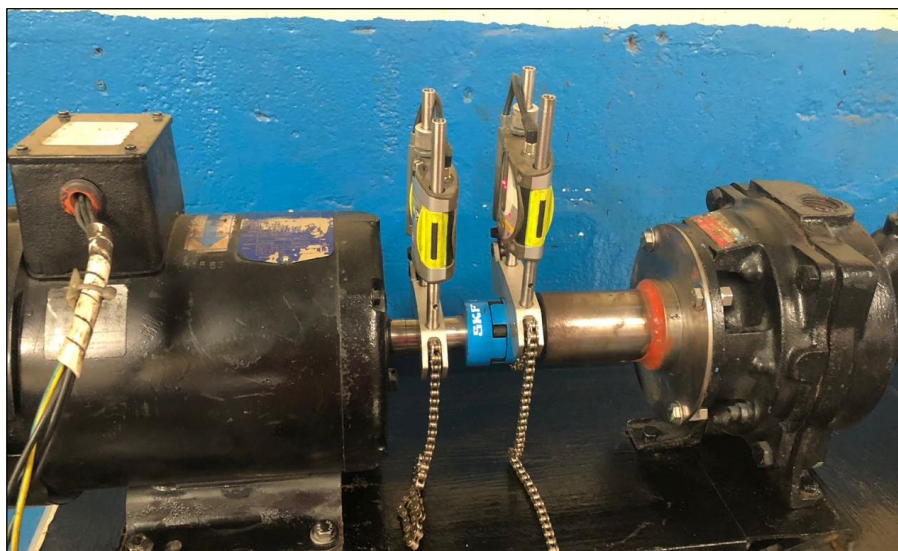
Figura 8. 10 Toma de la muestra de desalineación posición vertical Elaborado: El autor
