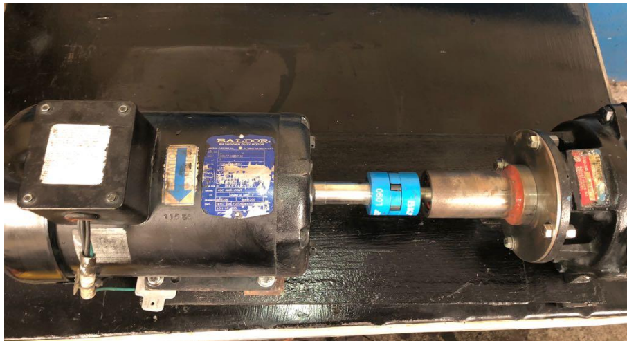
Figura 7. 2 Montaje del estacionario con la base y acoplamiento Elaborado: El autor
