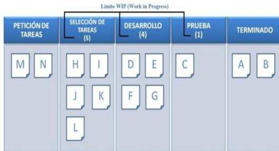
Figura 5. Esquema de trabajo KanBan. Tomado de Garzás (2011)
