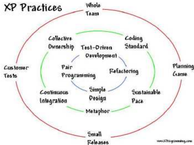
Figura 2. Modelo de extreme programming. Tomado de Figueroa-Díaz et al. (2007)
