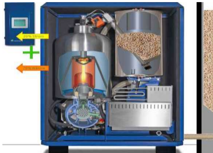
Figura 3. 2 Sistema de generación eléctrica a través de biomasa (pallets de madera)
