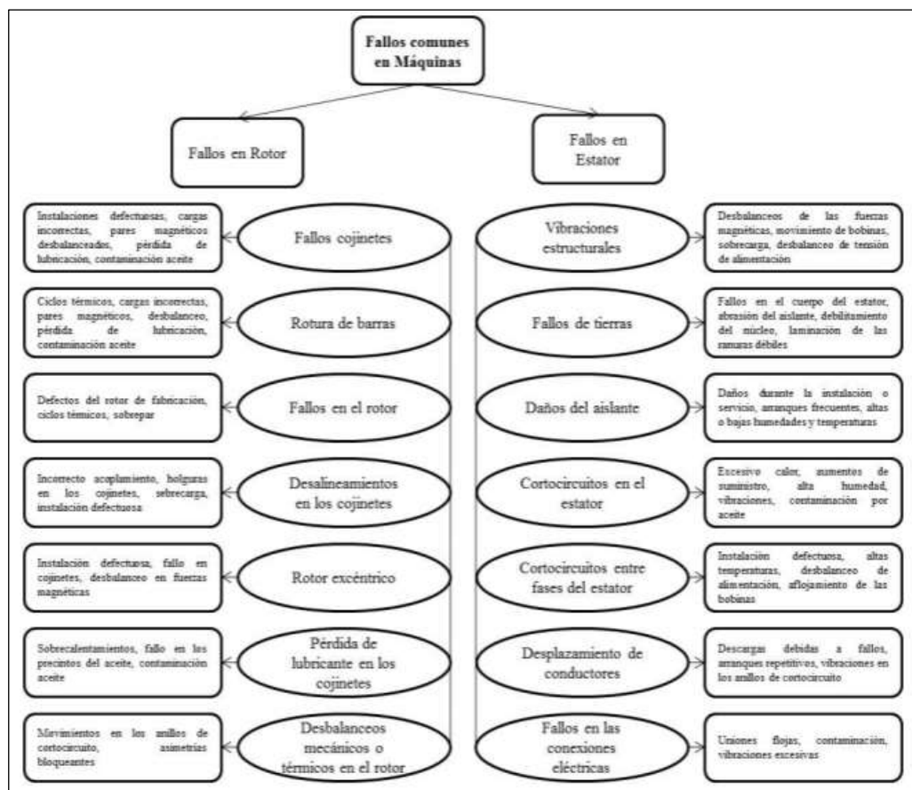
Figura: 2. 19 Clasificación de los principales fallos de máquinas eléctricas Fuente. (Singh, 2002)
