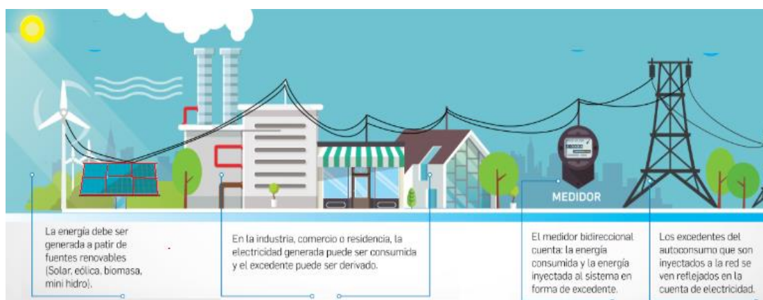
Figura 3. 1 Esquema de generación distribuida
