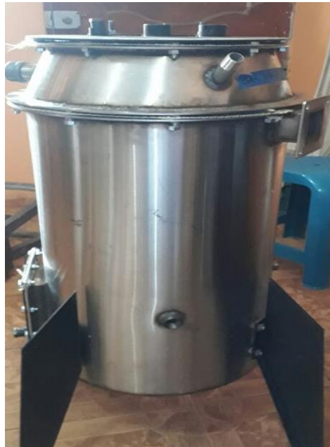
Figura 3. 14 Reactor del gasificador
