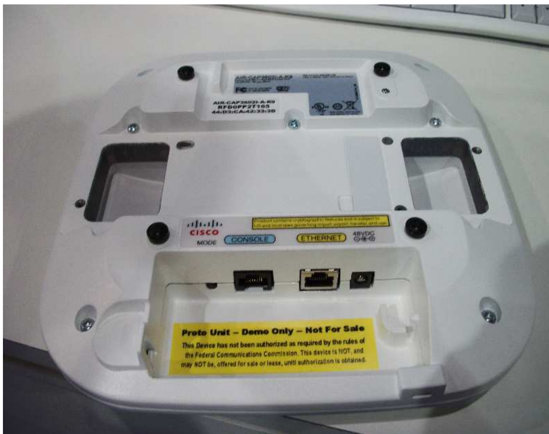
Figura 3. 13 Instalación de dispositivo CISCO Aironet 3600. Fuente: Autor
