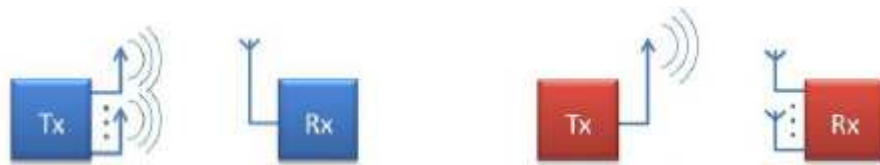
Figura 2. 6:Uso de la diversidad del transmisor/receptor en los sistemas MISO/SIMO
