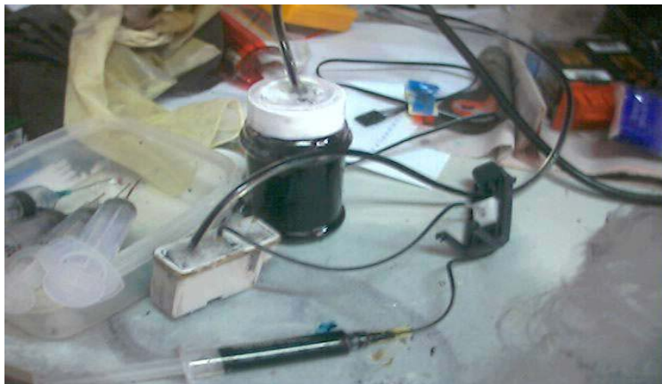
Figura 2.7 Imagen de la botella o recipiente llena de tinta, la manguera atravesando al tapa hasta el fondo de este y sellado con silicona. Además podemos apreciar las mangueras atravesando a través del seguro del cabezal.
