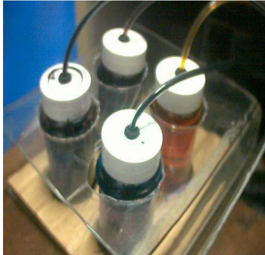
Figura 2.8 Fotografía que muestra la base o receptáculo fabricado para que nuestras botellas no se caigan y así evitar derrames de tinta, además de hacer mas fácil el transporte junto a la impresora, además pueden ver que para una mejor presentación les puse unas gomas en lugar de silicona, el punto negro que se ve en la botella inferior es el respiradero de aire para lograr el efecto de succión desde el cabezal.
