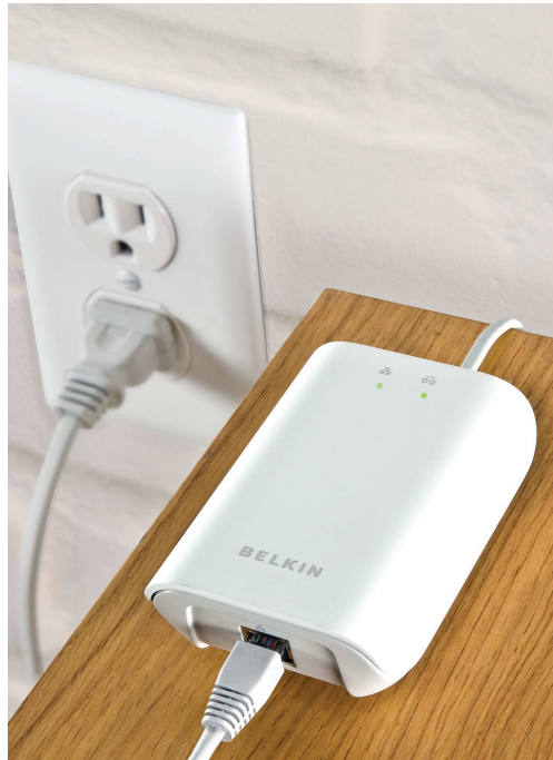
Figura 2.2: Adaptador Belkin PLC con extensión de cable
