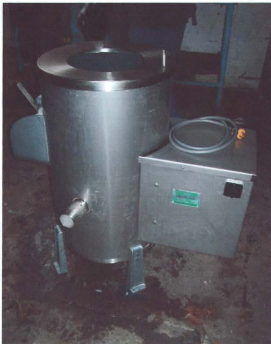
FOTO DE PELADORA Y LAVADORA DE PAPAS INDUSTRIALES, CAMOTE, LIMON ETC. DE ACERO INOXIDABLE
