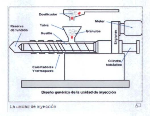
La tecnología que usaremos será el método de moldeo por inyección, proceso que consiste en amasar la materia prima, en este caso el poliestireno e introducirlo por medio de un tornillo que gira en el interior de un cilindro caliente, para después encajar la materia prima bajo presión dentro de un molde bien cerrado y que de esta manera se obtenga la forma deseada.
