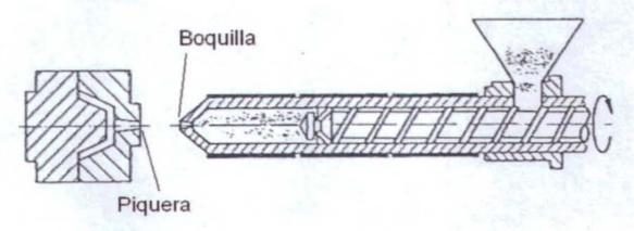
2.- Se mantiene la presión en el molde, inyectando más material durante inicio de cristalización y contracción. 3.- Separación del molde, y comienzo de nuevo ciclo de plastificación mientras la pieza termina el enfriamiento en el molde.
