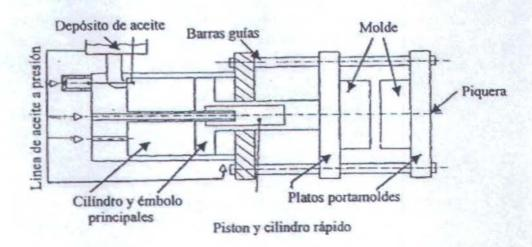
Características más importantes: dimensiones máximas de los moldes y fuerza de cierre (hasta 1000 ton en hidráulicas y superior en hidromecánicas).
