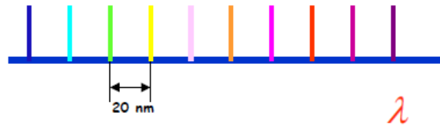
Figura 3. 27: Separación entre canales de longitudes de onda de 20 nm. Elaborado por: Autor.
