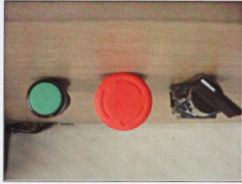
Figura 4.27: Selector, boton de parada de emergencia, luz piloto. (Fotografía tomada durante el desarrollo de pruebas eléctricas).
