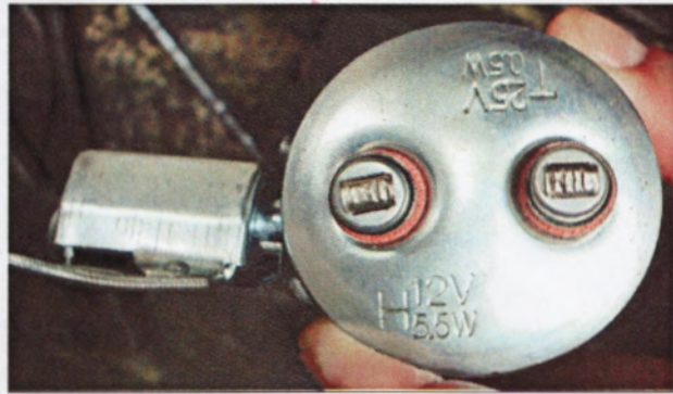
Figura 4.9: Terminales de la dinamo. (Fotografía tomada durante el desarrollo de pruebas eléctricas).
