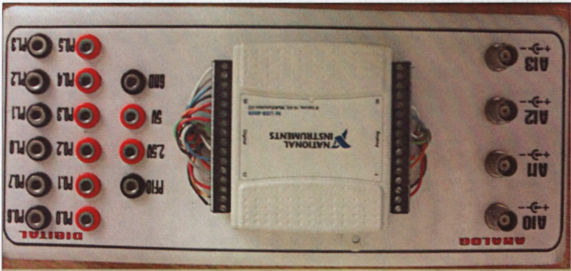
Figura 4.24: Tarjeta USB-6009, I/O's analógicas y digitales. (Fotografía tomada durante el desarrollo de pruebas eléctricas).
