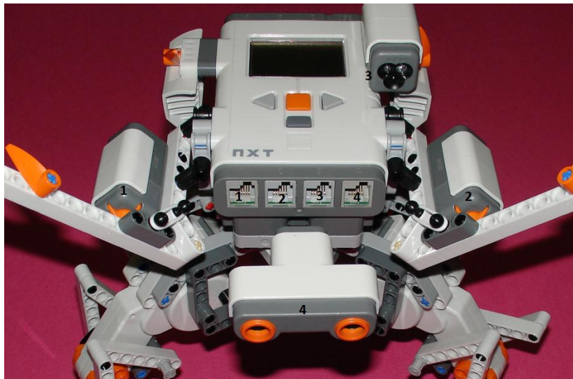
Figura 4. 23: Vista de la conexión entre los puertos del NXT y los sensores del robot hexápodo Strider.
