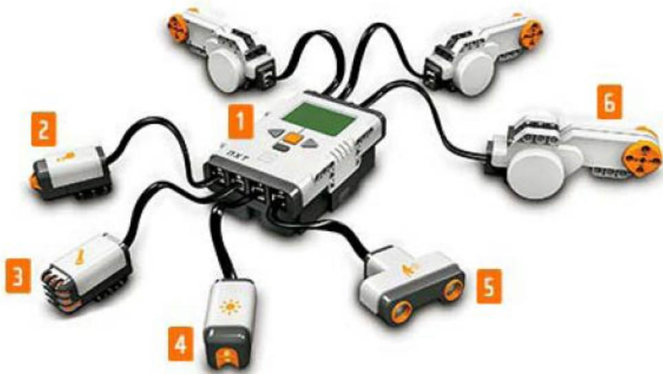
Figura 2. 13: Partes principales del LEGO Mindstorms NXT que son: [1] Microcontrolador NXT, [2] Sensor de contacto, [3] Sensor de sonido, [4] Sensor de luz, [5] Sensor de ultrasonido y [6] Servomotores.
