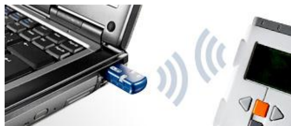
Figura 2. 24: Comunicación inalámbrico entre PC y NXT a través del bluetooth. Fuente: Los Autores
