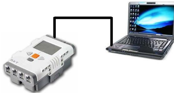
Figura 2. 23: Comunicación entre PC y NXT a través del cable USB. Fuente: Los Autores
