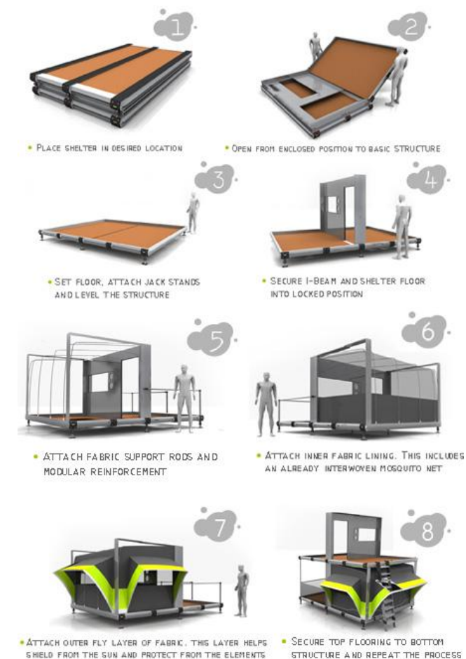
Imagen 229: Proceso de construcción rápida del refugio portátil Uber Shelter. (Domokyo, 2010)
