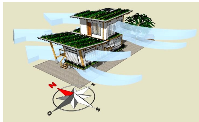
Imagen 236: Perspectiva digital de la propuesta conceptual con los vientos predominantes de la zona con dirección sur-norte y una insolación de muestra a las 15:00 un 12 de noviembre.
