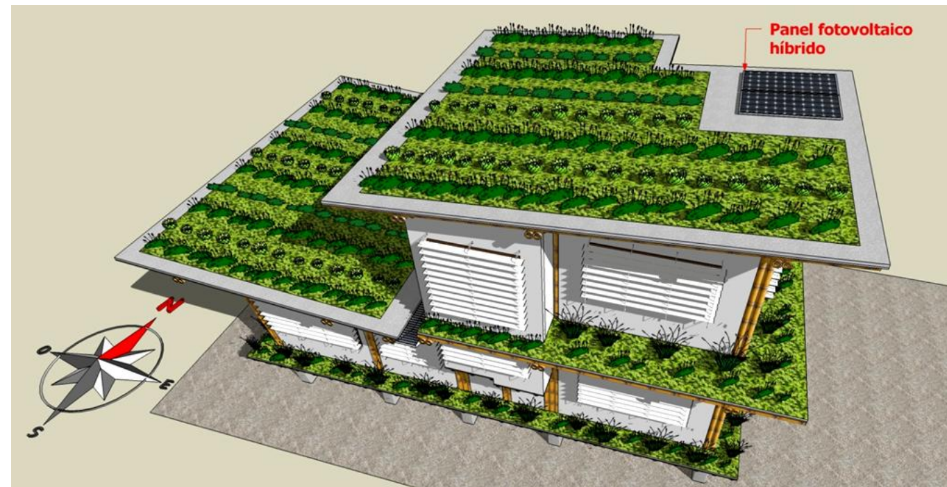
Imagen 254: Perspectiva de la vivienda conceptual con el panel fotovoltaico híbrido en la cubierta de la planta alta.
