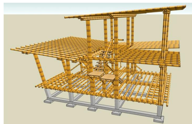
Imagen 244: Perspectiva de la estructura de caña guadúa y cimientos de hormigón armado fachada Sur.
