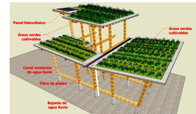
Imagen 249: Vista general de la cubierta verde cultivable y sus diferentes componentes.
