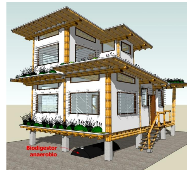
Imagen 256: Ubicación del biodigestor anaerobio semi enterrado debajo de la vivienda en la parte posterior.
