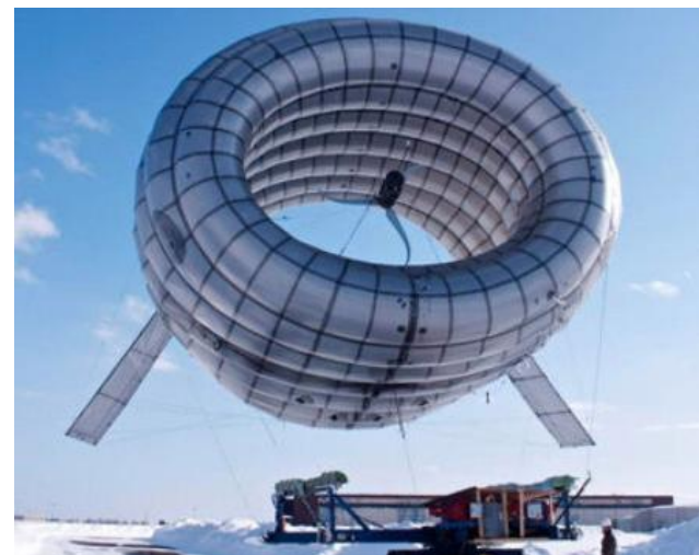
Imagen 161: Acercamiento del prototipo de aerogenerador flotante. (RT, 2012)
