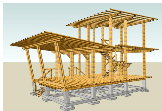
Imagen 242: Perspectiva de la estructura de caña guadúa y cimientos de hormigón armado.
