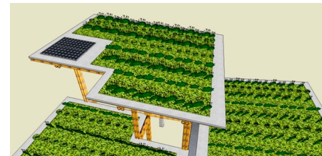
Imagen 251: Cubierta en planta alta con el panel fotovoltaico y cultivo de alimentos.
