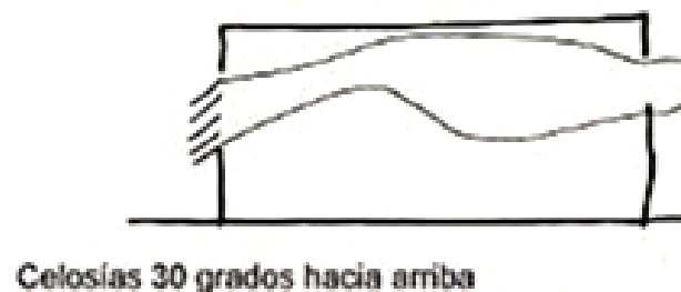
Imagen 106: Esquema gráfico de varias alternativas de control de flujo de aire a través de las aberturas. (Arq. Gabriel Murillo, 2007)
