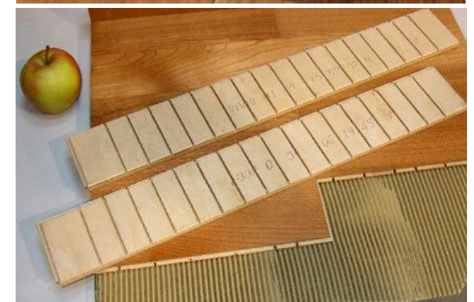
Imagen 141: Distintos tipos de acabados de madera para piso y aglomerados (MDF) piso flotante. (Google imágenes, 2012)
