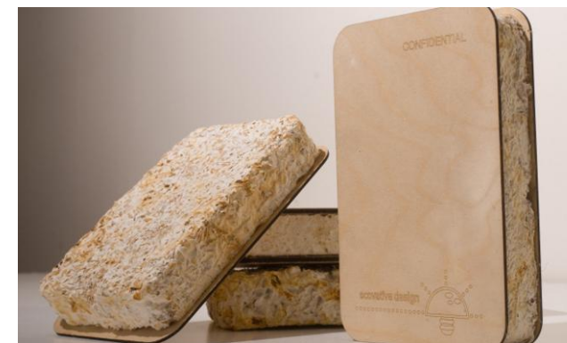
Imagen 207: MycoBond y sus características adaptables como aislante térmico. (Sanz, 2012)
