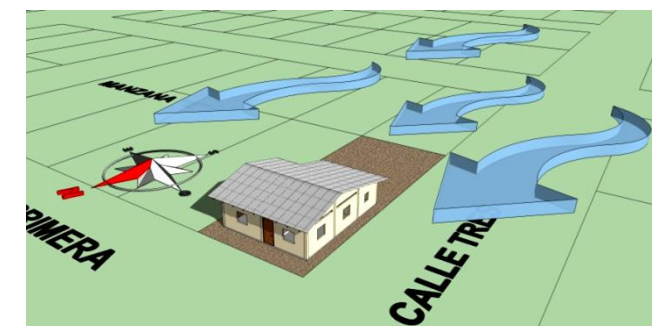
Imagen 54: Modelo digital de la vivienda representando dirección del viento.
