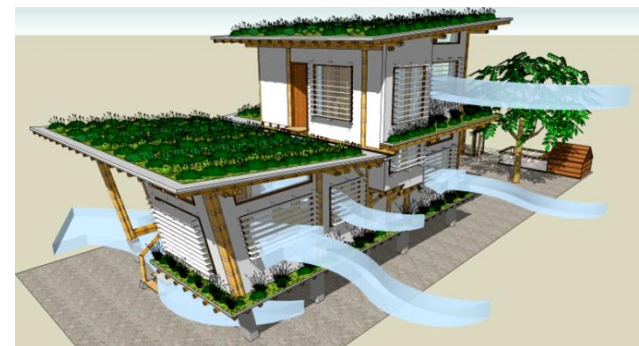
Imagen 238: Perspectiva digital del concepto de vivienda y las áreas verdes bajas ayudan a enfriar el aire que ingresa.
