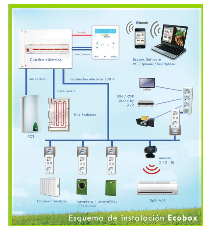
Imagen 210: Esquema de instalación y funcionalidad del Ecobox. (Marsilli, 2005)
