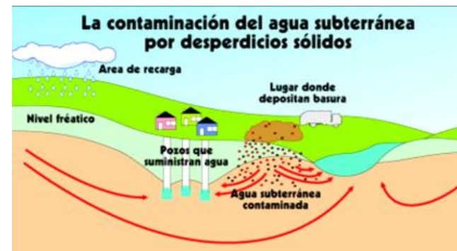
Imagen 40: Esquema gráfico de contaminación de agua subterránea por desechos sólidos. (Wikipedia, Agua subterránea, 2012)
