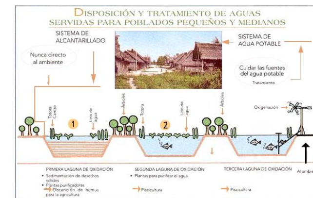
Imagen 41: Esquema gráfico del sistema de tratamiento de aguas servidas para poblados pequeños y medianos.
