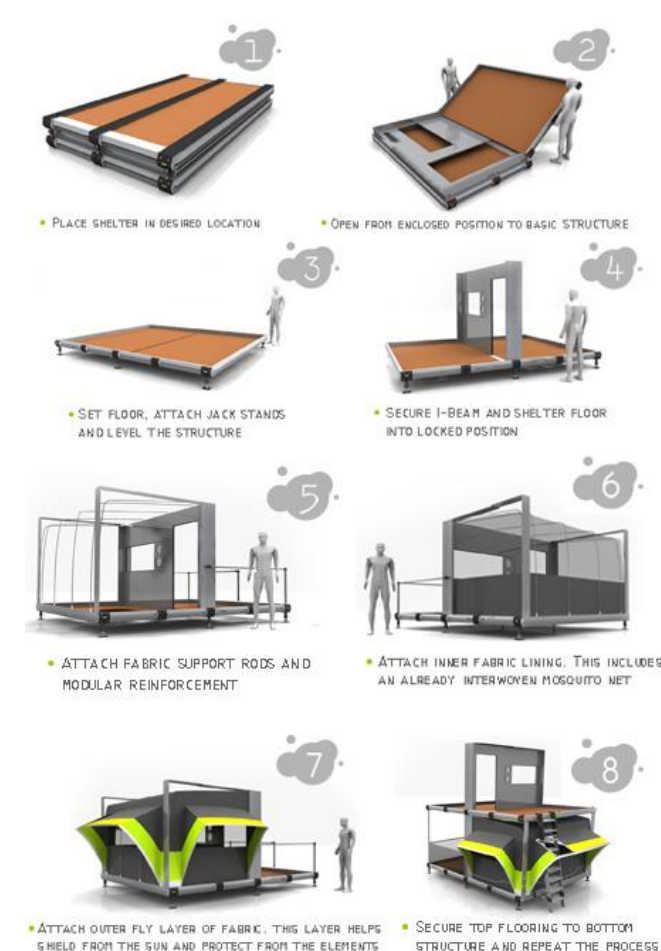
Imagen 195: Proceso de construcción rápida del refugio portátil Uber Shelter. (Domokyo, 2010)
