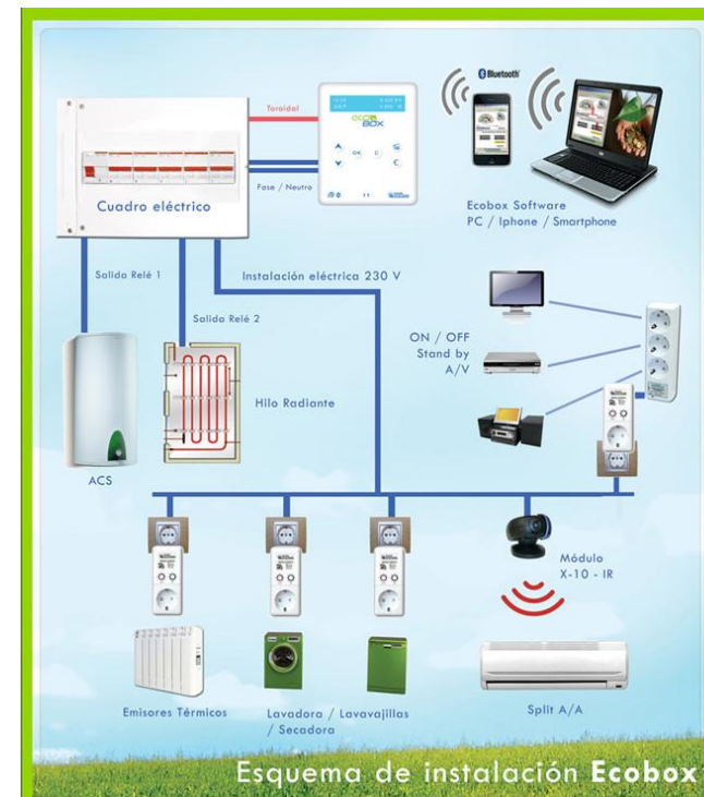
Imagen 255: Esquema de instalación y funcionalidad del Ecobox. (Julio, 2010)
