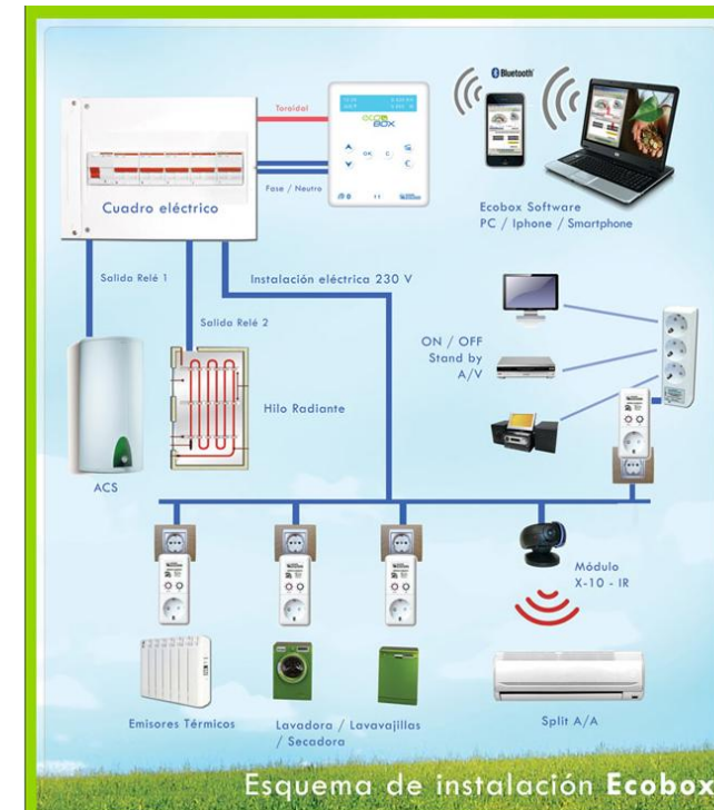
Imagen 164: Diagrama del funcionamiento del sistema de control energético doméstico EcoBox. (Julio, 2010)
