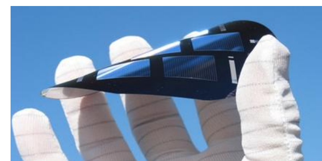
Imagen 155: Muestra conceptual de célula fotovoltaica flexible. (Ecogaia, 2012)
