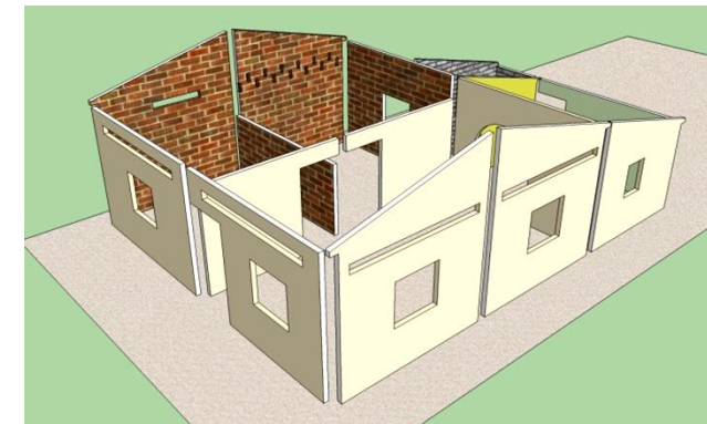
Imagen 57: Modelo digital de las paredes de ladrillo simple visto y las enlucidas con mortero de cemento.
