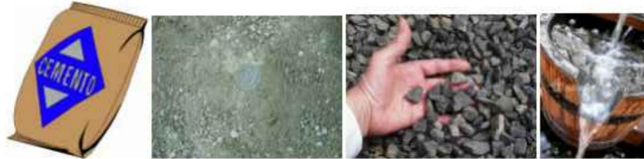
Gráfico 8: Componentes HORMIGÓN. Fuente: Temas de Hormigón armado-Escuela politécnica del ejército-Ecuador.
