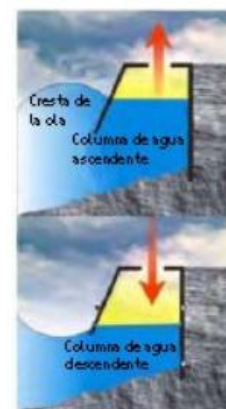
Turbina inventada por Zeimor en 1970. La turbina gira en un mismo sentido en los dos ciclos de la ola.
