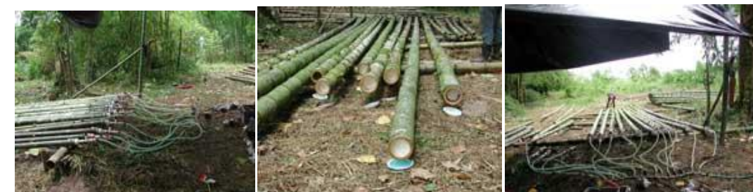
Imagen 48. Preservación de Guadua angustifolia mediante el método de Boucheri modificado. Estación Experimental Los Diamantes, Guápiles, Costa Rica.
