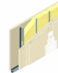
Imagen 31. paneles de yeso o cemento (vista pared doble)
