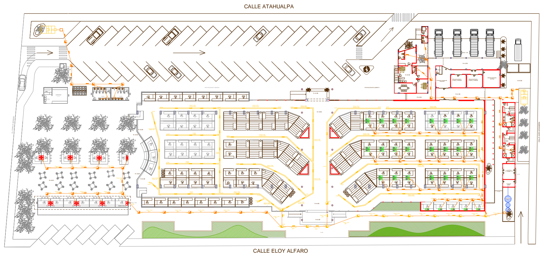
INSTALACIONES SANITARIAS AGUAS SERVIDAS (AASS) ESC 1:350
