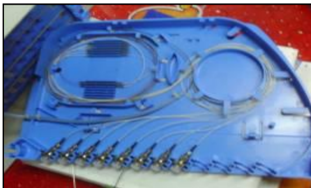
Figura 4.32: Organización de fibras en bandeja
