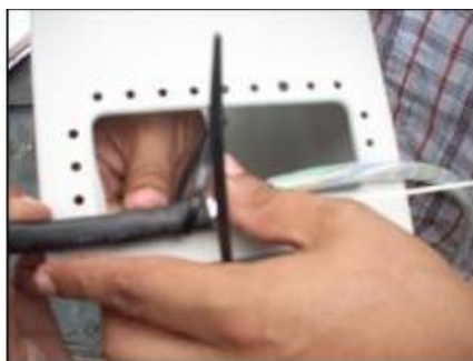
Figura 4.21: Colocación de amarras (a)
