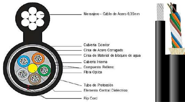
Figura 2.4: Imagen del cable ADSS Fuente: (ITA, 2014)
