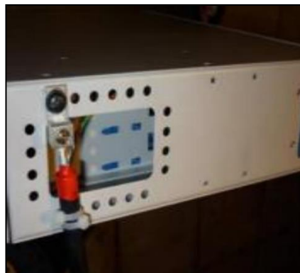
Figura 4.20: Fijación de cable con un conector talón eléctrico
