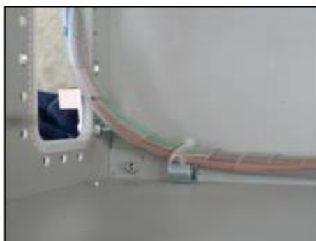
Figura 4.27: Fijación de buffers en el terminal
