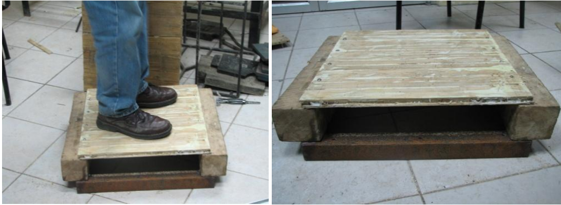
Placa Ecu-Bam código C001 fijada en dos apoyos
