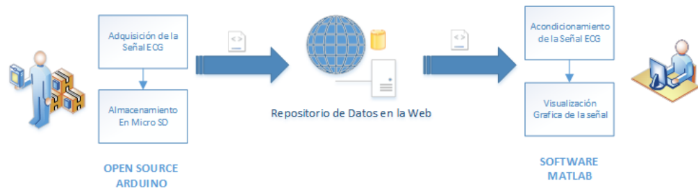
Figura 1. 1: Diagrama de adquisición de la señal ECG
