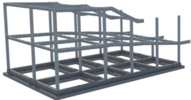
Figura 18. Proceso constructivo - tercera fase: planta alta 1 Autor: Bermúdez (2018)
