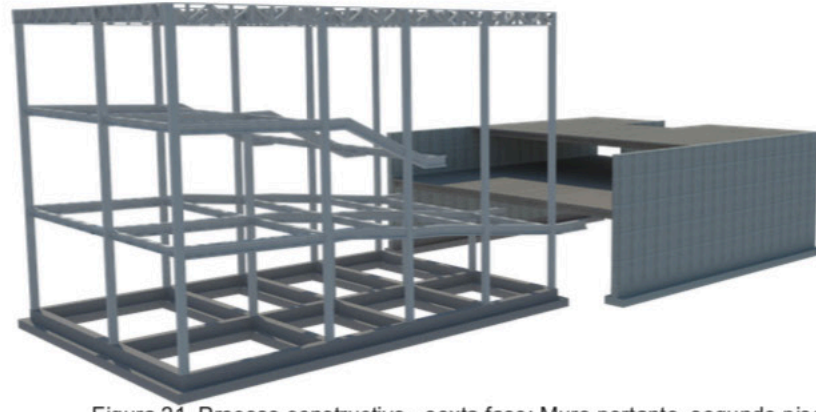
Figura 21. Proceso constructivo - sexta fase: Muro portante, segundo piso Autor: Bermúdez (2018)
