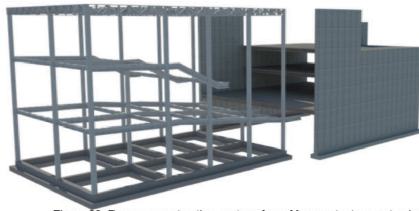
Figura 23. Proceso constructivo - octava fase: Muro portante, cuarto piso Autor: Bermúdez (2018)
