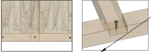
3.- Fijación ensamble media madera en tiras de 6x3cm con tornillos autorroscantes de 3 pulg
