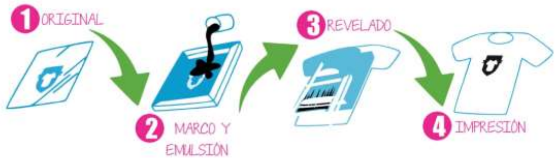
Figura 20. Proceso de impresión en serigrafía Fuente: http://screenpad.com.mx/serigrafia-cilindrica/
