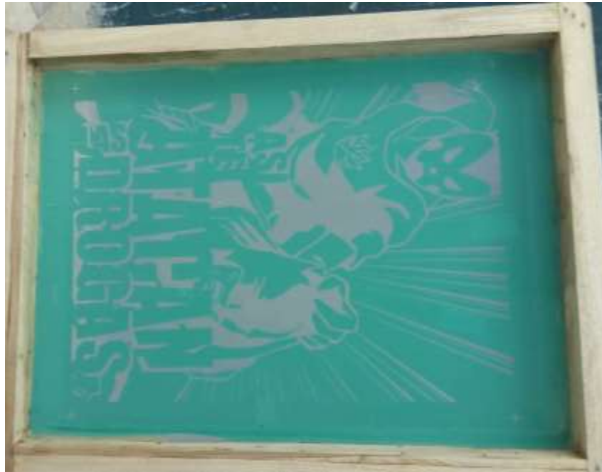
Figura 2300 Pruebas de revelado para impresión en serigrafía Fuente: realizado por screen serigrafía – Eduardo Salazar
