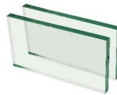
**Figura 99:** vidrio de 10mm de espesor
